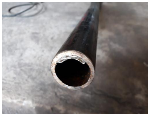
Gambar Pipa dengan Tebal 3 mm
