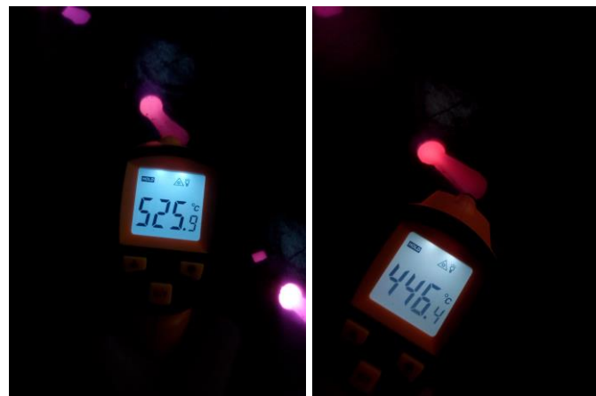
Foto hasil uji temperature dengan Infrared Thermometer AMF-500
