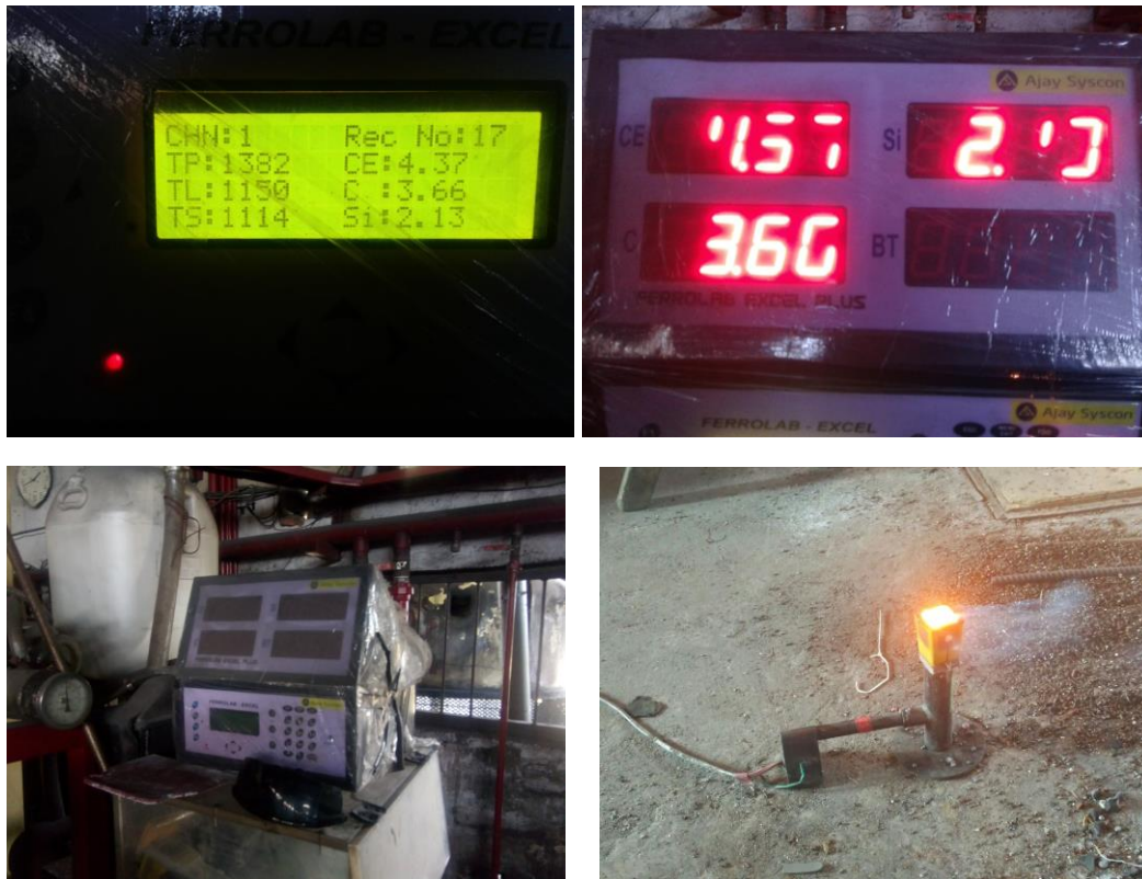
Foto hasil uji komposisi kimia dengan alat CE meter
