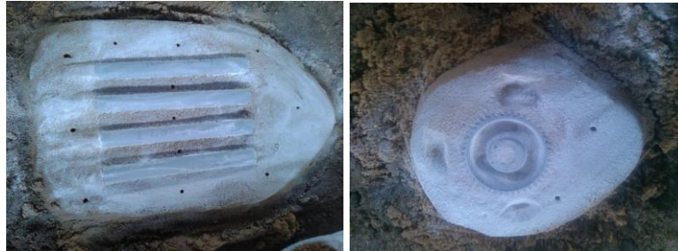
Gambar 3.4 pelepasan pola pada cetakan.
