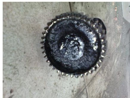
Gambar 3.10 pengangkatan setelah dilakukan perlakuan panas.
