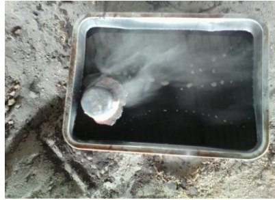
Gambar 3.8 proses perlakuan panas hasil dari pasir cetak kering.
