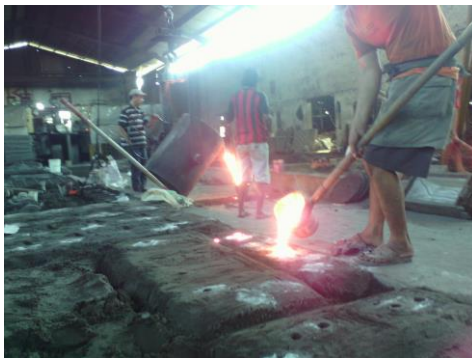
Gambar 3.5 penuangan logam cair kedalam cetakan.
