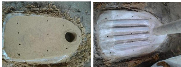
Gambar 3.3 pembuatan lubang penuangan cairan.
