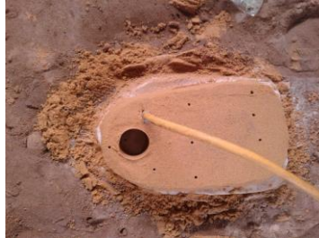
Gambar 3.2 proses pemberian gas \text{CO}_2 sebagai media pengerasan pada cetakan pasir kering. (Sumber CV. Kembar Jaya, 2018)
