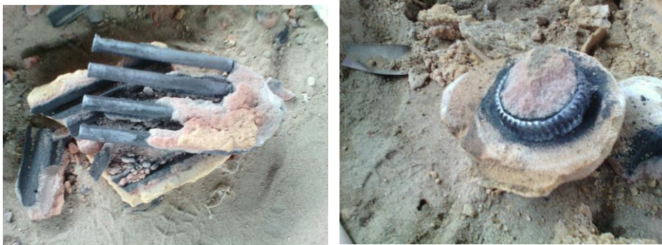
Gambar 3.6 pembongkaran material dari cetakan.
