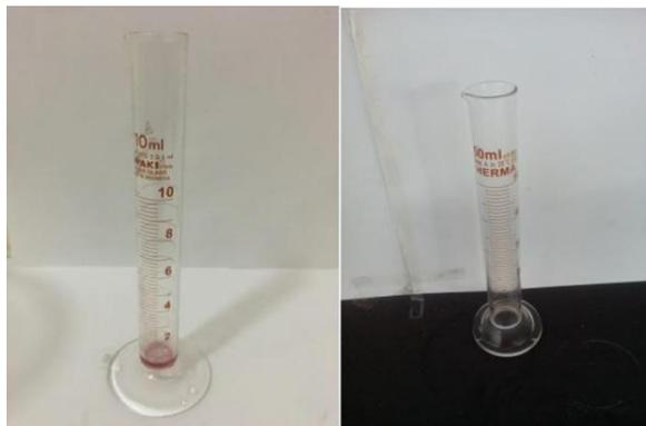
Gambar 3.9 Gelas Ukur 10 ml (kiri), Gelas Ukur 50 ml (kanan).
