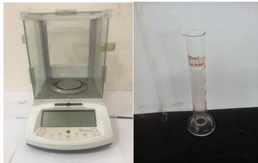
Gambar 3.14 Timbangan dan Gelas ukur untuk Pengujian Densitas
