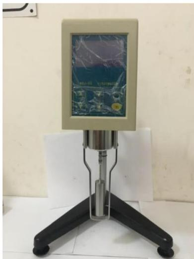
Gambar 3.21 Rangkaian Viskometer
