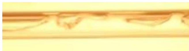
Gambar 2.4 : Slug flow pada pipa horizontal ( J_L=0.012 m/s, J_G=2,64 m/s) ( Badarudin dkk, 2014)
