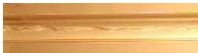
Gambar 2.5 : Wavy flow pada pipa horizontal ( J_L=0.012 m/s, J_G=2,31 m/s) ( Badarudin dkk, 2014)
