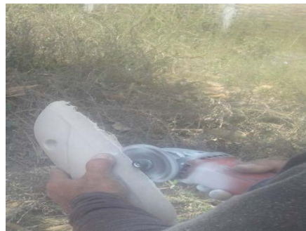
Gambar 4.19 Pemotongan cover bagian samping
