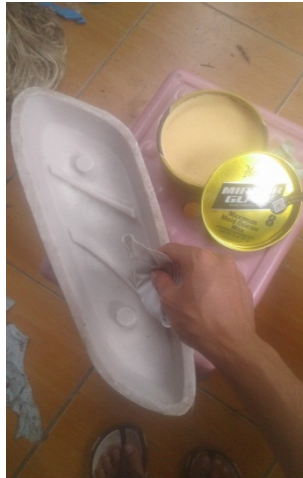
Gambar 4.11 Pelapisan mirror glaze pada molding
