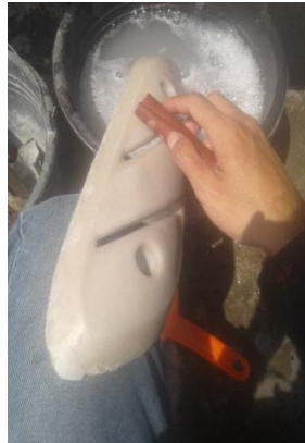
Gambar 4.22 Pengampelasan pada bagian luar cover
