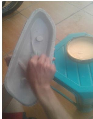
Gambar 4.2 Pelapisan mirror glaze pada molding
