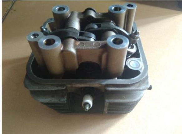
Gambar 2.2 Kepala silinder (*cylinder head*)
