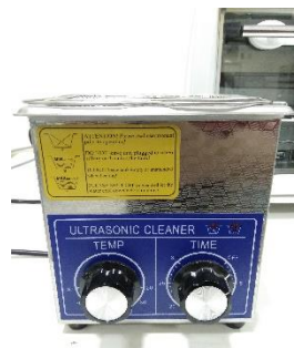
Gambar 3.5 Ultrasonic cleaner type ps-10A dengan kapasitas tangka 2 L dan temperatur sampai 80°
