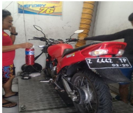
Gambar 3.3 Proses pengujian dynotest menggunakan dynamometer
