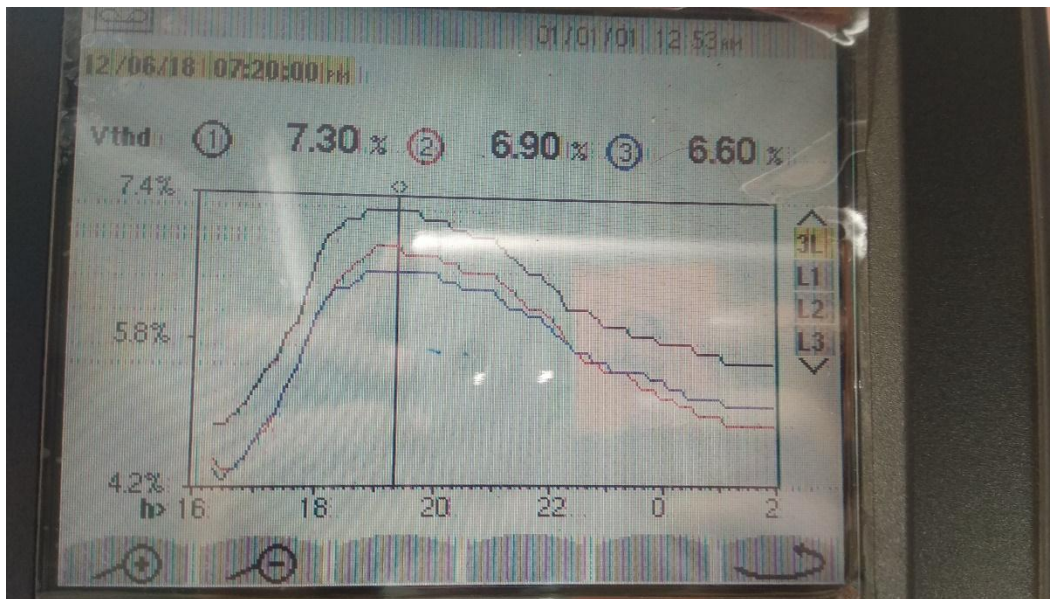
Gambar 4.15 Nilai Harmonisa Tegangan Panel SDP 6 Desember 2018 s/d 7 Desember 2018
