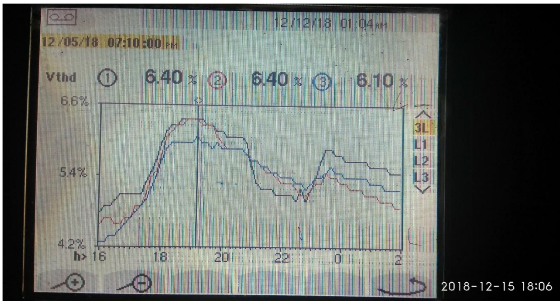
Gambar 4.4 Nilai Harmonisa Tegangan Panel SDP 5 Desember 2018 s/d 6 Desember 2018
