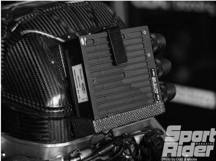
**Gambar 4. Engine Control Unit tunggal untuk 2016**
