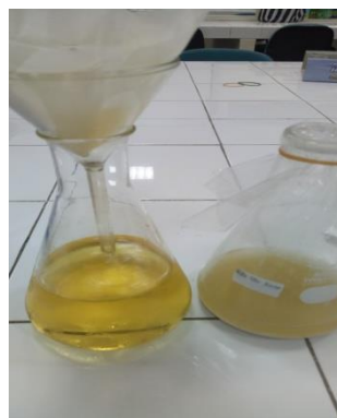
f. Penyaringan filtrat dengan kertas saring
