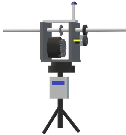
Gambar 3. 23 Peletakan Box Sensor Processing
