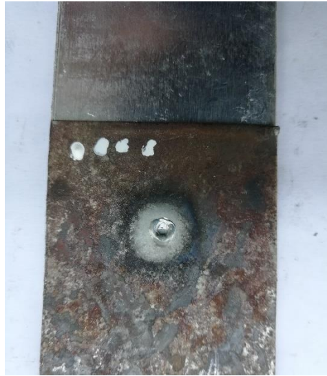
Gambar 2.3 Permukaan nugget hasil lasan spot TIG welding pada sisi material baja karbon rendah
