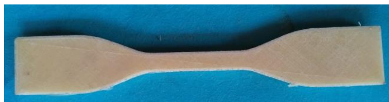
Gambar 3.18. Pencetakan Spesimen dengan Layer Heigh 0.2
