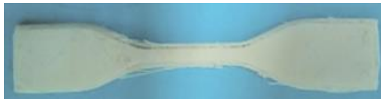
Gambar 3.17. Pencetakan Spesimen dengan Layer Heigh 0.1
