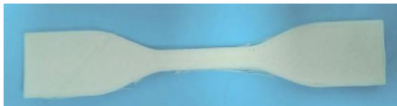
Gambar 3.19. Pencetakan Spesimen dengan Layer Heigh 0.4
