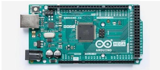
Gambar 2.5. Arduino Mega 2560
