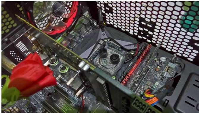
Gambar 4.6. Pemasangan *Water Block* dan *Fitting*
