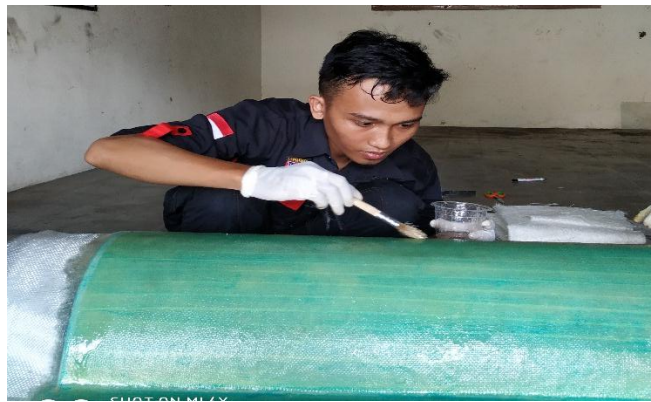
Gambar 3.39 Proses pembuatan sudu kincir angin
