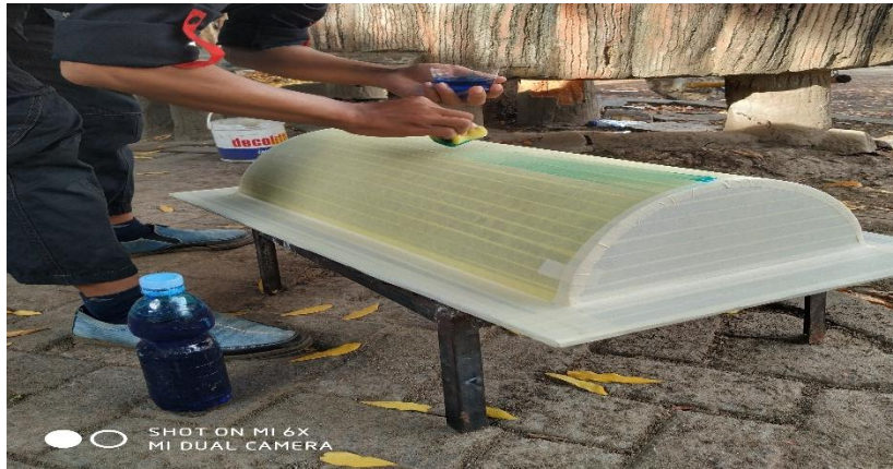
Gambar 3.37 Proses pengolesan cairan pva
