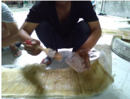
Gambar 4.4 Proses Menyetak Produk Lapisan Kedua
