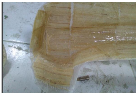
Gambar 4.7 serat rami dipotong kecil dan ditempelkan pada cetakan lapisan kedua
