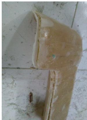
Gambar 4.10 Penggabungan Kedua Bagian Untuk Mengatur Kepresisian
