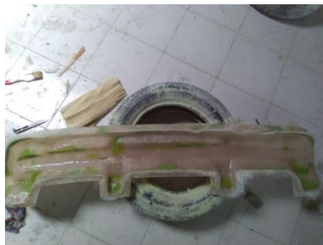
Gambar 4.6 Proses Menyetak Produk Pada Cetakan Bagian Bawah Lapisan Pertama
