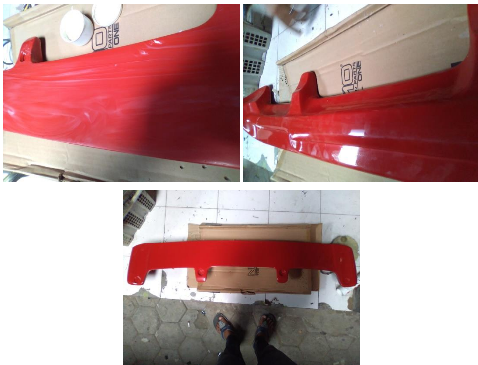
Gambar 4.19 Spoiler Setelah Dipoles Dengan Kompon
