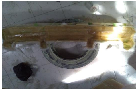
Gambar 4.8 Proses Menyetak Produk Lapisan Ketiga
