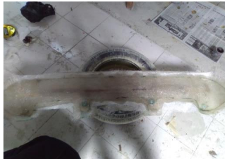
Gambar 4.3 Proses Menyetak Produk Pada Cetakan Bagian Atas Lapisan Pertama
