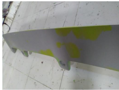
Gambar 4.16 Spoiler Didempul Pada Bagian Yang Masih Berlubang
