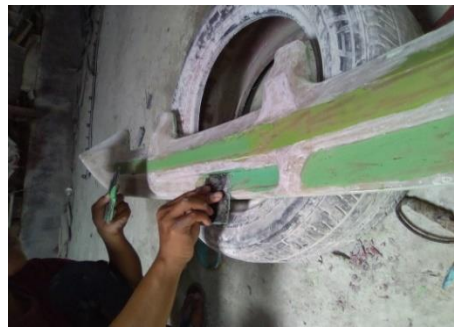
Gambar 4.13 Proses Mendempul Pada Spoiler
