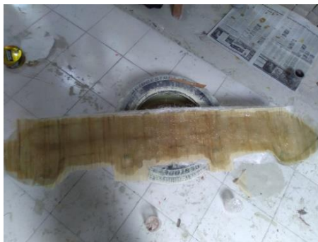
Gambar 4.5 Proses Menyetak Produk Lapisan Ketiga
