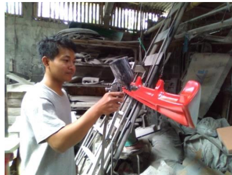
Gambar 4.17 Proses Spoiler Saat Dicat Merah
