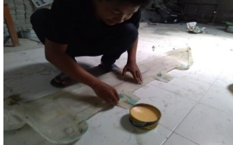
Gambar 4.1 proses pengolesan mirroglaze pada cetakan
