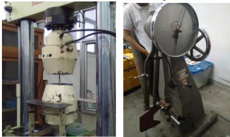
Gambar 3. Alat uji tarik servopulser dan alat uji impak charpy
