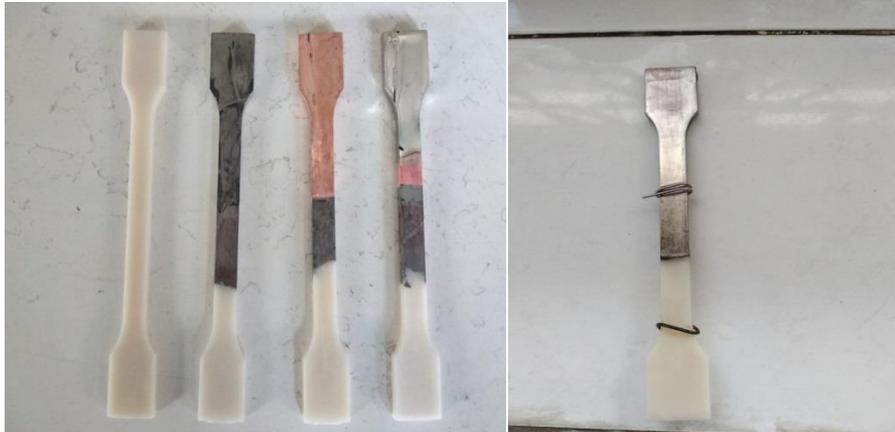
**Gambar 4.1.** Hasil Pelapisan Plastik ABS
