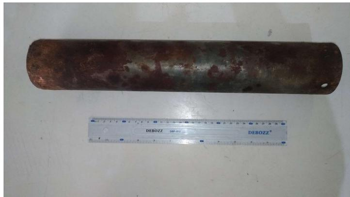
Gambar 3. 7 Tabung besi tipis untuk contoh tanah uji.
