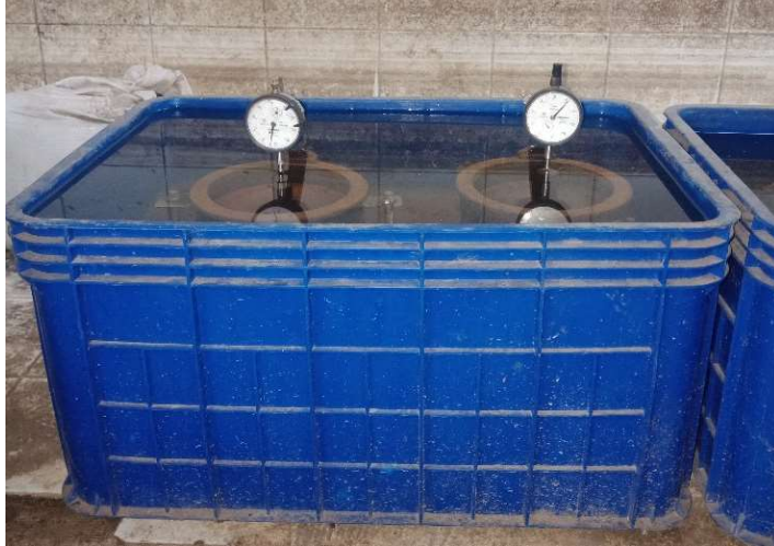
Gambar 3.21. Pengujian Pengembangan ( Swelling )
