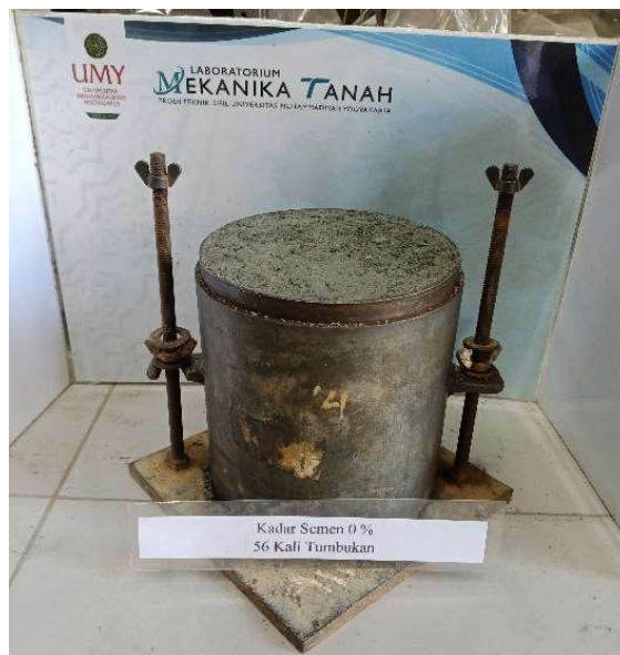
Gambar 3.18. Benda Uji CBR dengan Kadar 0% (a) 0x Tumbukan, (b) 25x Tumbukan, (c) 56x Tumbukan
