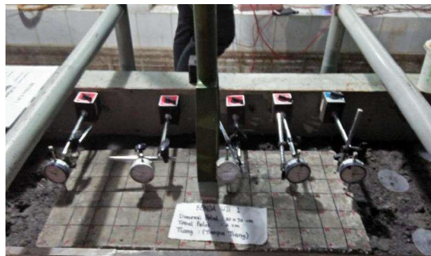
Gambar 3.9 Pemasangan dial gauge
