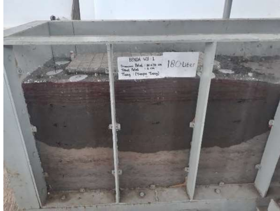
Gambar 3.12 Ilustrasi kedalaman air yang meresap pada tanah
