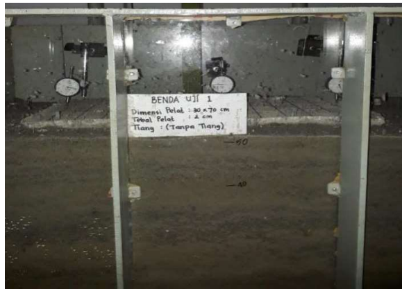
Gambar 3.11 Kondisi pelat dan tanah sebelum pembasahan
