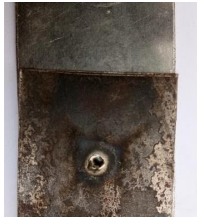
Gambar 2. 3 Permukaan Nugget hasil lasan spot TIG welding pada sisi material baja karbon rendah
