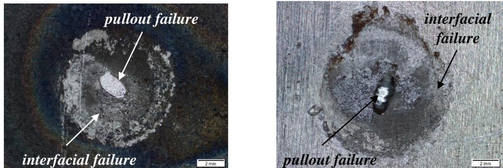
Gambar 4. 23 Fraktografi A) Baja karbon rendah dan B) aluminium 1100 variasi waktu 8 detik.
