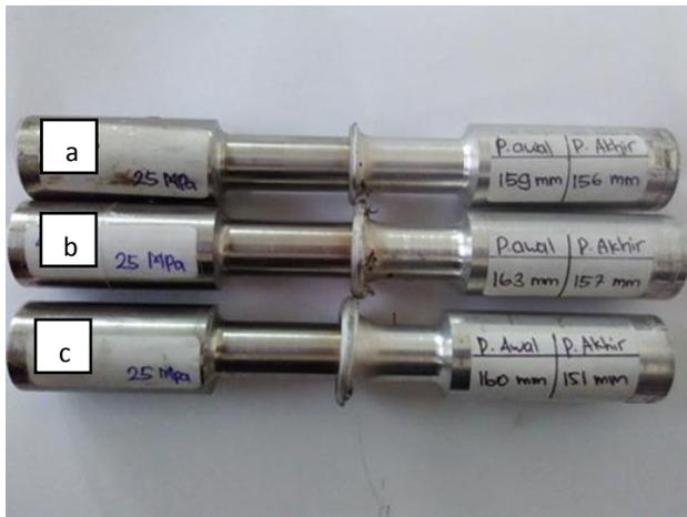
**Gambar 5.** Hasil sambungan pengelasan gesek waktu gesek (a) 2 detik (b) 4 detik (c) 6 detik.
