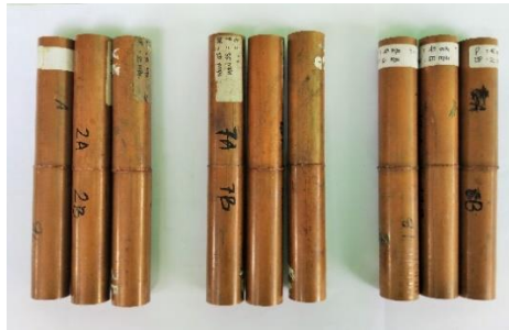
Gambar 4. Hasil Pengelasan Gesek Pipa Tembaga
