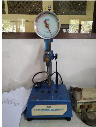
Gambar 3.14 Alat uji penetrasi
