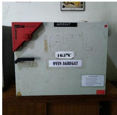
Gambar 3.12 Oven agregat
