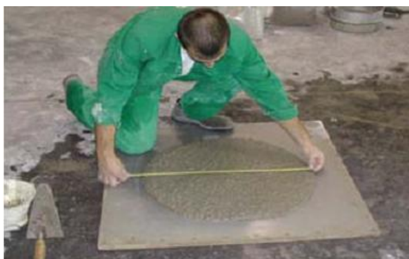
Gambar 2.4 Pengukuran diameter beton pada uji slump-flow (EFNARC, 2005)
