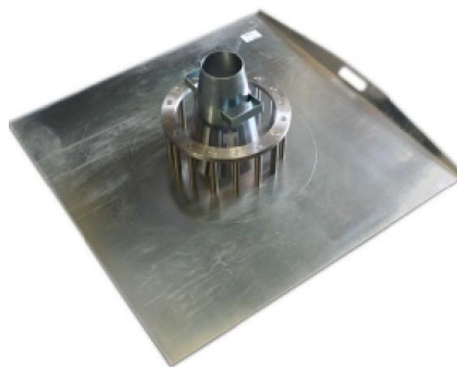
Gambar 2.7 Bentuk alat pengujian J-ring (EFNARC, 2002)
