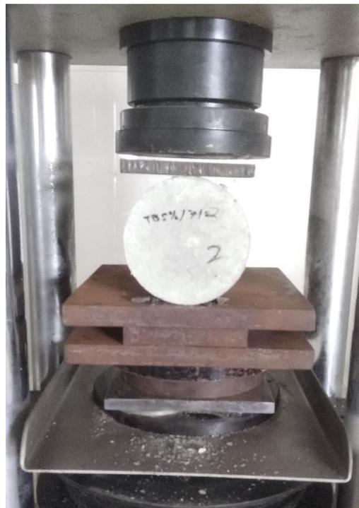
Gambar 2.6 Penempatan benda uji pada mesin uji tekan
