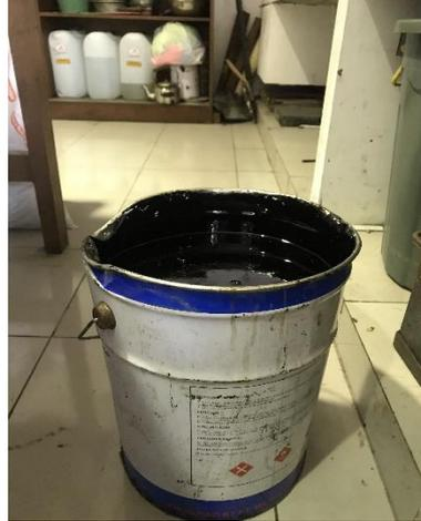
Gambar 3.1 Aspal Penetrasi 60/70
