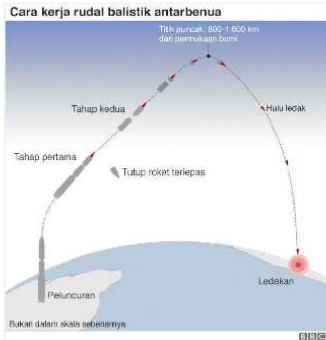
Gambar 2.1 Cara Kerja Rudal Balistik Antar Benua Sumber: (BBC, 2017)
