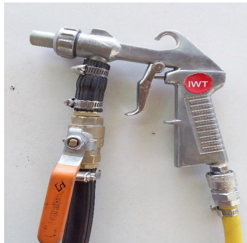
Gambar 4.12 Gun blasting dan noozle blasting
