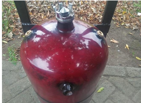
Gambar 4.2 pembuatan lubang potblasting
