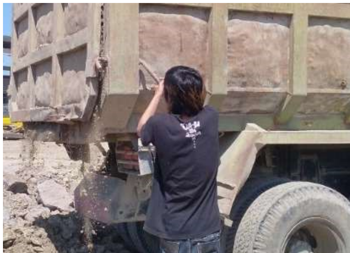
Gambar 4.8 Pembukaan pengait pintu bak DT oleh driver sebelum melakukan dumping .
