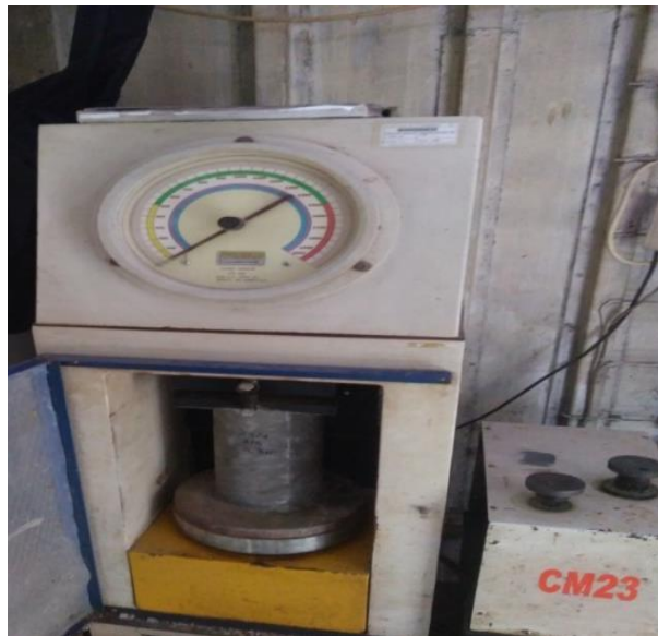
Gambar 4.9 Proses Pengujian Kuat Tekan Beton
