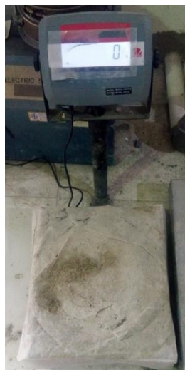
Gambar 3.12 Timbangan dengan ketelitian 5 gram
