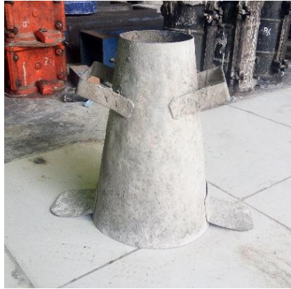
Gambar 3.8 Kerucut Abrams untuk uji fresh properties
