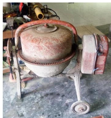
Gambar 3.7 Mixer Concrete dengan kapasitas 40 kg
