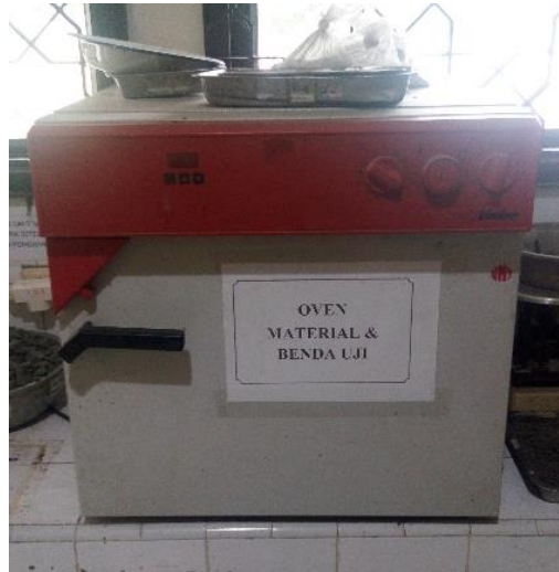
Gambar 3.13 Oven dengan suhu maksimal 220^{\circ}\text{C}
