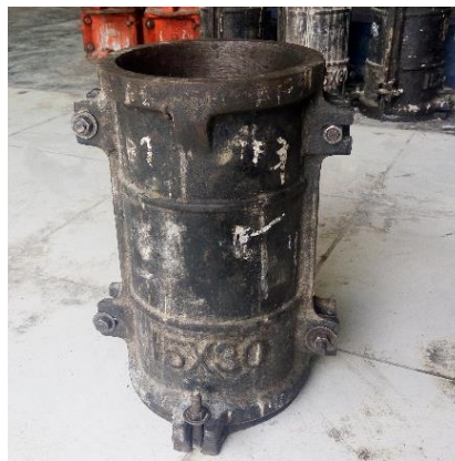
Gambar 3.9 Silinder cetakan beton
