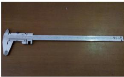
Gambar 3.11 Kaliper dengan ketelitian 0,05 mm
