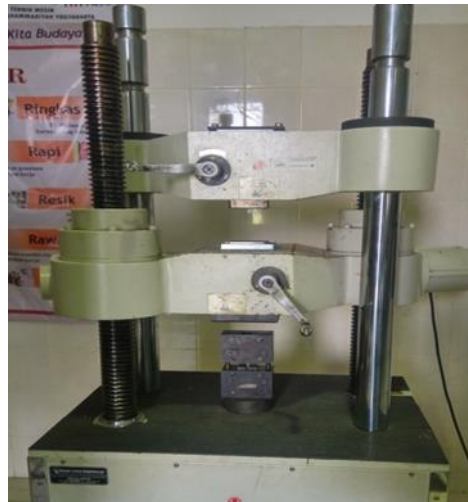
Gambar 3.28. Pemasangan Grip pada Mesin UTM.
