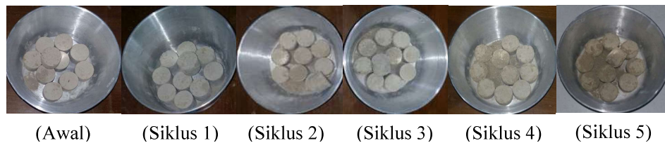
Gambar 4.4 Bentuk Spesimen A setelah Pengujian Slake Kadar Semen 10% Dry Mixed
