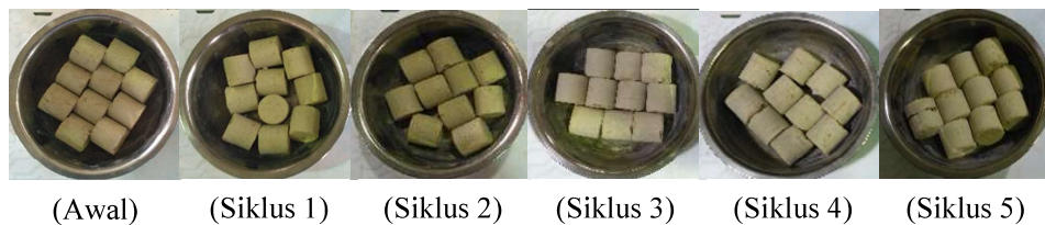
Gambar 4.5 Bentuk Spesimen A setelah Pengujian Slake Kadar Semen 10% Spray Mixed
