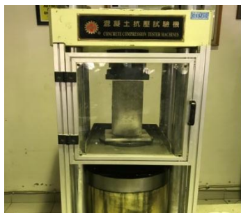
Gambar 2 Penempatan benda uji pada mesin uji tekan
