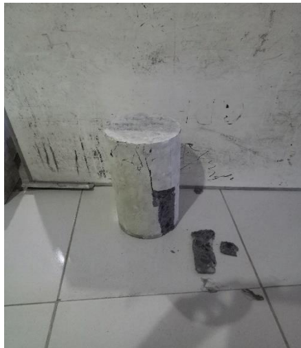
Gambar 5. Beton normal setelah dilakukan uji tekan
