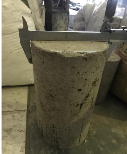
Gambar 2. Pengukuran diameter benda uji silinder
