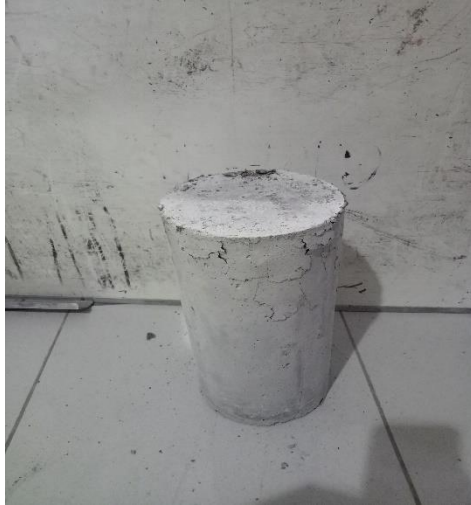
Gambar 6. Beton serutan ban bekas setelah dilakukan uji tekan
