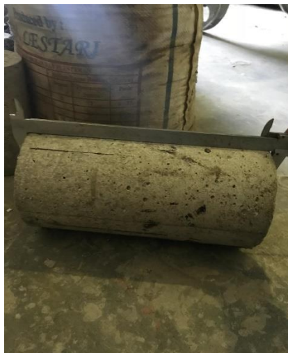
Gambar 3. Pengukuran tinggi benda uji silinder
