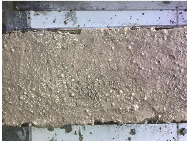
Gambar 4.4 Bleeding pada beton segar saat pencetakan benda uji
