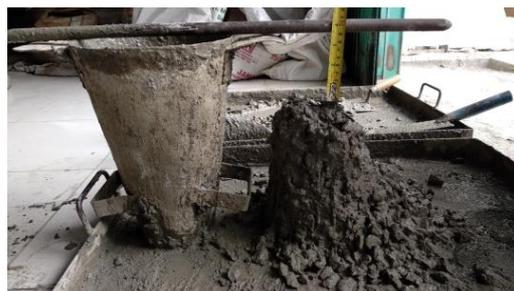
Gambar 4. 1 Hasil *slump test* pada campuran beton
