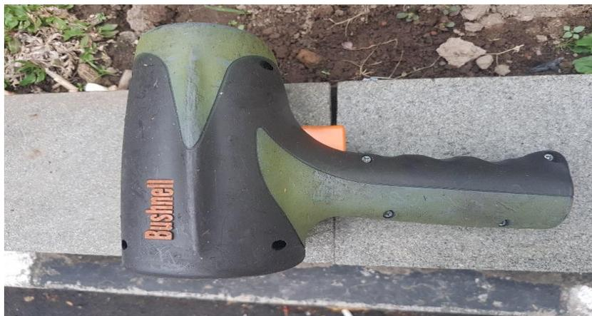
Gambar 3.5. *Alat Speed Gun* untuk mengukur kecepatan kendaraan
