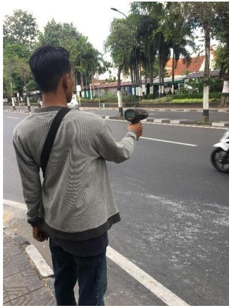
Gambar 3. 5 Survei kecepatan kendaraan dengan *speedgun*
