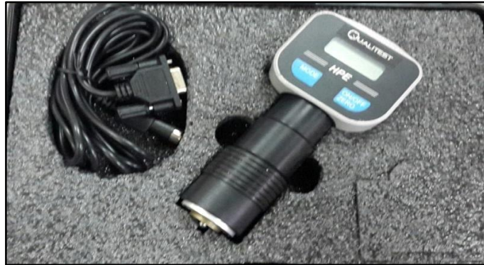
Gambar 3.6 Alat pengujian kekerasan Shore D (dalam Hameed, 2015).
