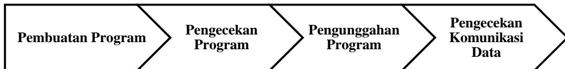
Gambar 3.2 Diagram alur perancangan dummy data menggunakan Arduino (Dibuat pada 1 Maret 2019 pukul 08.32)
