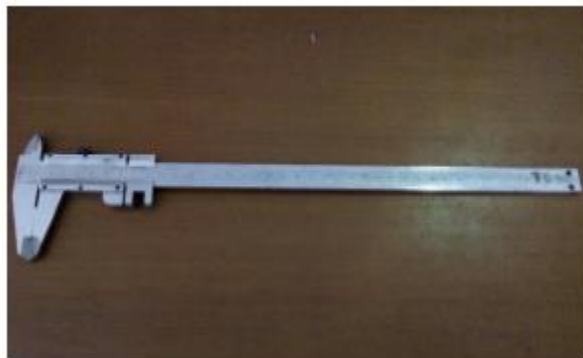
Gambar 3. 11 Kaliper dengan ketelitian 0,05 mm.
