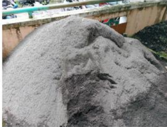
Gambar 3. 4 Agregat halus (pasir).
