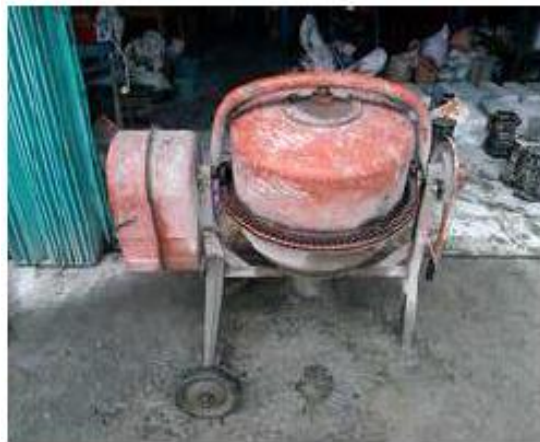
Gambar 3. 7 Mixer Concrete dengan kapasitas 40 kg.
