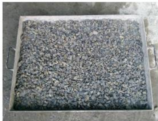
Gambar 3. 3 Agregat kasar (kerikil).
