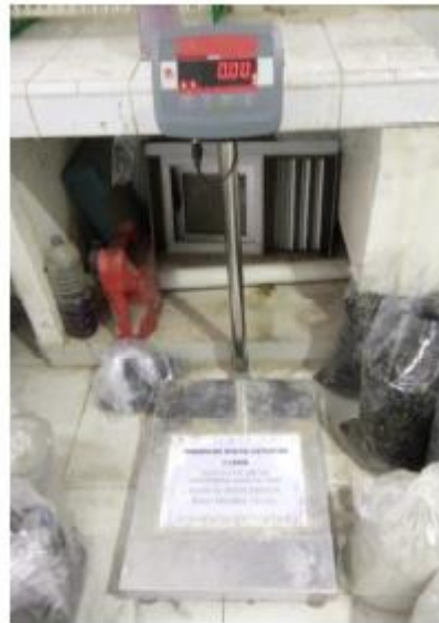
Gambar 3. 12 Timbangan dengan ketelitian 5 gram.
