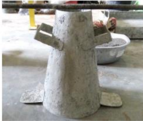
Gambar 3. 8 Kerucut Abrams untuk uji fresh properties .
