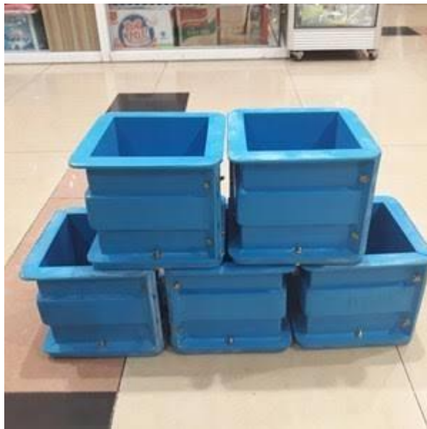
Gambar 3. 9 Kubus cetakan beton.
