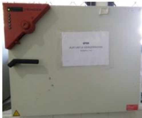
Gambar 3. 13 Oven dengan suhu maksimal 220^{\circ}\text{C} .
