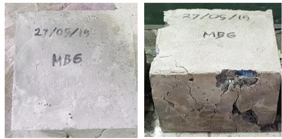
Gambar 7 Beton campuran 6% : (a) MB6 sebelum pengujian (b) MB6 setelah pengujian.
