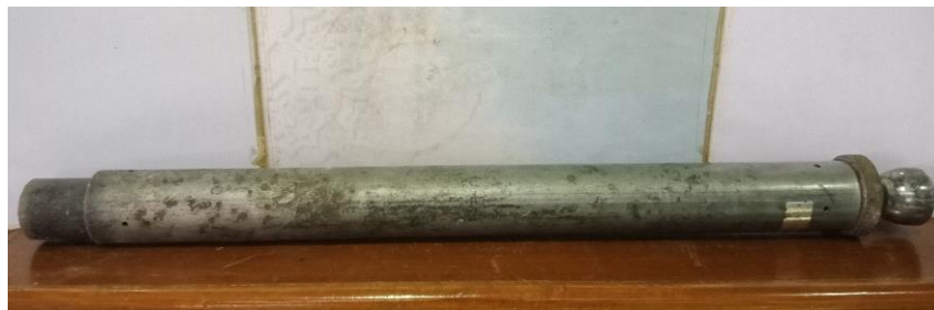
Gambar 3.3 Penumbuk Pemadatan CBR
