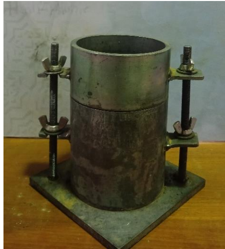
Gambar 3.2 Silinder Pemadatan CBR
